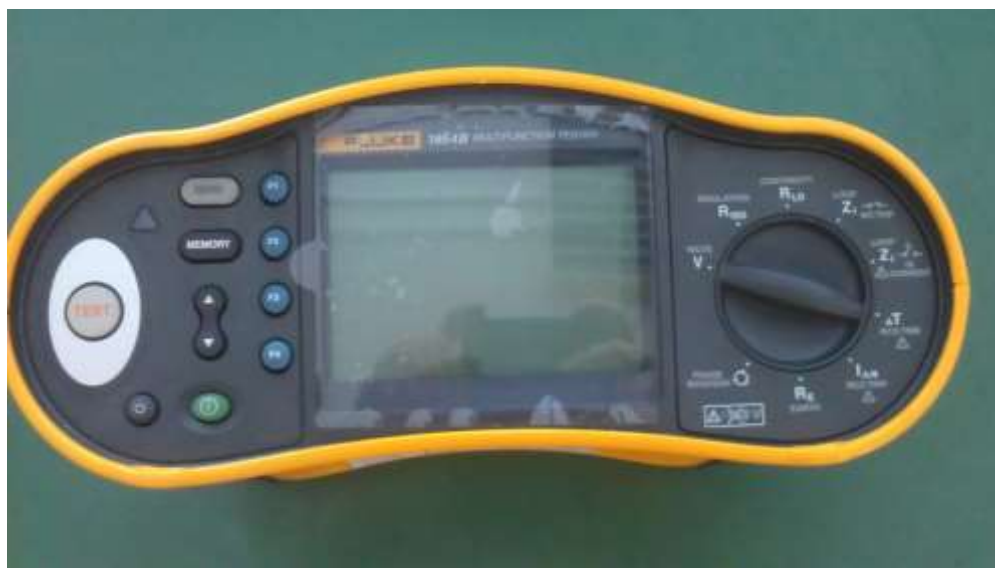
Slika 1. Fotografija uređaja FLUKE 1654B
